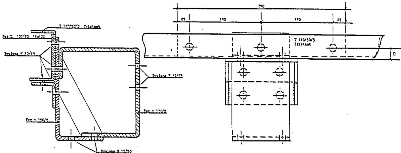
Garantierte Anhängelast gebremst : 3'000 kg mit verstärktem Fahrgestell (siehe Zeichnung auf der Rückseite)
